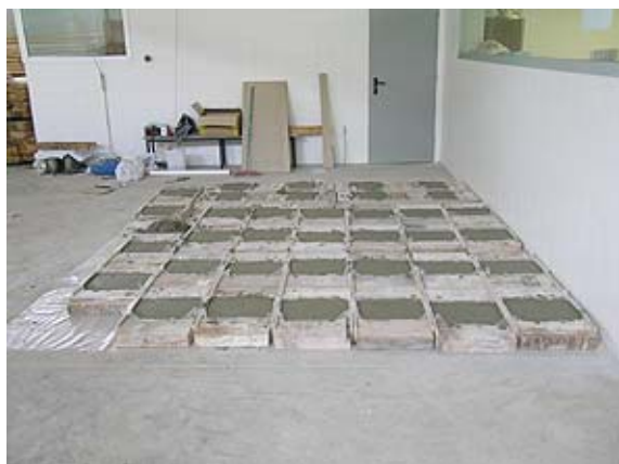
Figuras 7 y 8. Probetas mixtas para ensayo a cortante.
